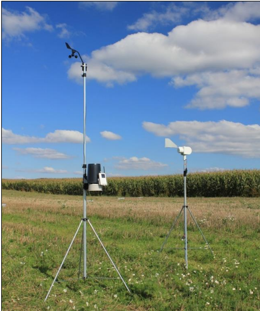
Abb. 165: Mobile Meteorologie-Messstation mit Funkdisplay und Datenlogger (Davis Vantage Pro II), Windmesser (Richtung und Geschwindigkeit) in 3 m Höhe, Temperatur-, Feuchte- und Niederschlagssensor in 1,5 m; rechts volumetrischer Aerosolsammler Sporewatch (1,8 m Höhe, 10 l/min; Burkard Scientific Ltd.) (Bild: Hofmann)
