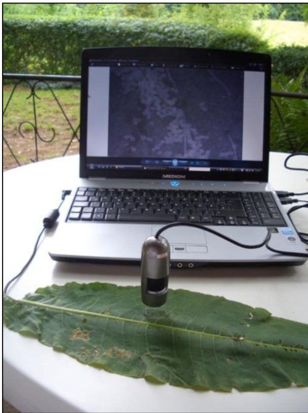
Abb. 98: Portables Digitalmikroskop Dino-Lite Pro 1.3 MP betrieben am USP-Port des Notebooks mit 8 LED-Ringbeleuchtung an einem Rumex -Blatt auf dem Labortisch und rechts im Geländeeinsatz. (Bild: Hofmann)
