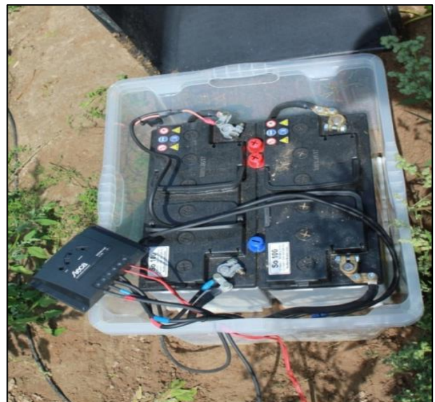
Abb. 76: Solarstation der 12V-Pollenmonitor-Messstationen (TIEM technic GbR) mit Solarmodul 12 V 80 W in 3 m Höhe auf Gestell mit verstellbarem Neigungswinkel (hier ca. 20°), rechts Solarakku-Zwischenspeicher mit 200 Ah Kapazität für mindestens 5 Tage Pufferlaufzeit (2 Solarbatterien 12 V à 100 Ah parallel geschaltet) und Solarregler. (Bilder: Hofmann)
