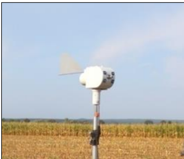
Abb. 156: Sporewatch zur Erfassung der Aerosolpartikel im Größenbereich von ca. 1 \mu\text{m} bis ca. 100 \mu\text{m} . Die Messungen erfolgten bei trockener Witterung ohne Regenschild. (Bild: Hofmann)
