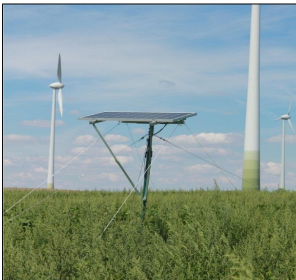
Abb. 76: Solarstation der 12V-Pollenmonitor-Messstationen (TIEM technic GbR) mit Solarmodul 12 V 80 W in 3 m Höhe auf Gestell mit verstellbarem Neigungswinkel (hier ca. 20°), rechts Solarakku-Zwischenspeicher mit 200 Ah Kapazität für mindestens 5 Tage Pufferlaufzeit (2 Solarbatterien 12 V à 100 Ah parallel geschaltet) und Solarregler. (Bilder: Hofmann)
