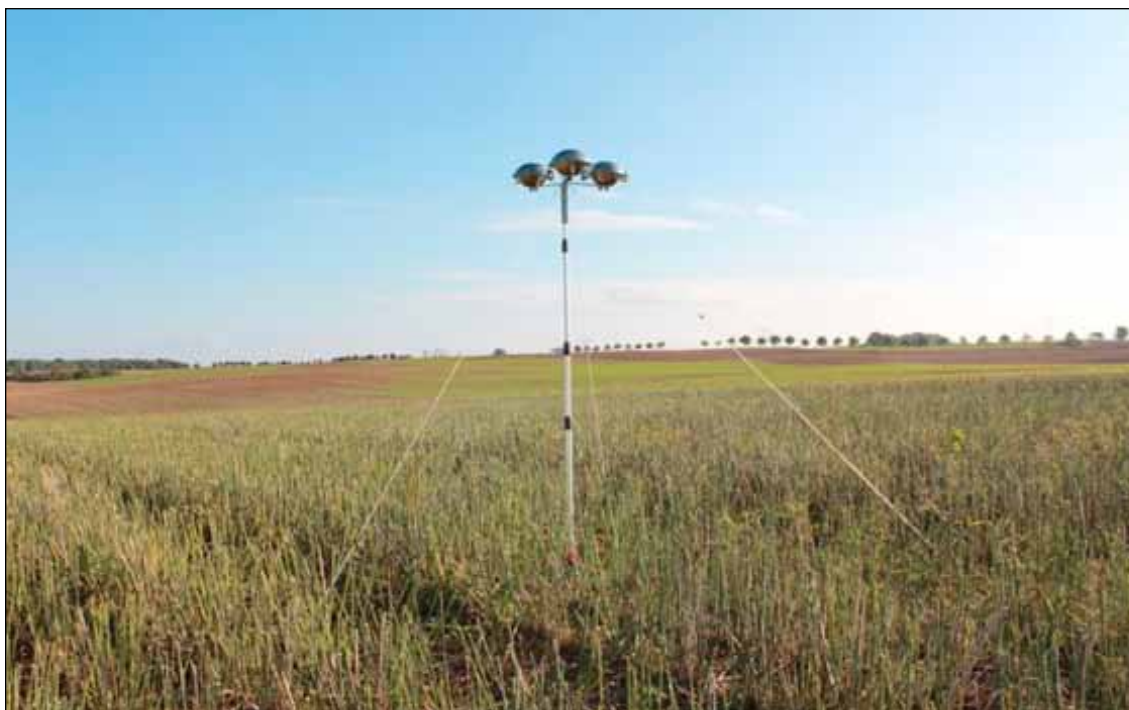
Abb. 20: Passivsammler-Einrichtung am Messpunkt P01, Körnerfenchel-Kultur bei Wilmersdorf
