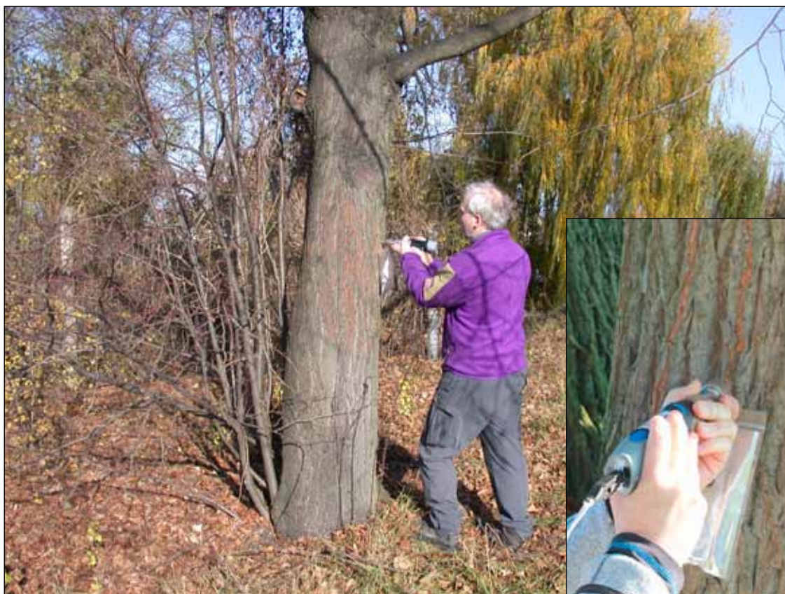
Abb. 13: Standardisierte Entnahme der äußeren Rinde zum Luftgüte-Rindenmonitoring mit dem Rindenprobenehmer (Archivbild Hofmann)
