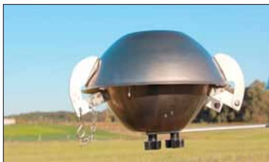
Abb. 15: Passivsammler des GAPS Networks für Außenluft der Firma Tisch Environmental
