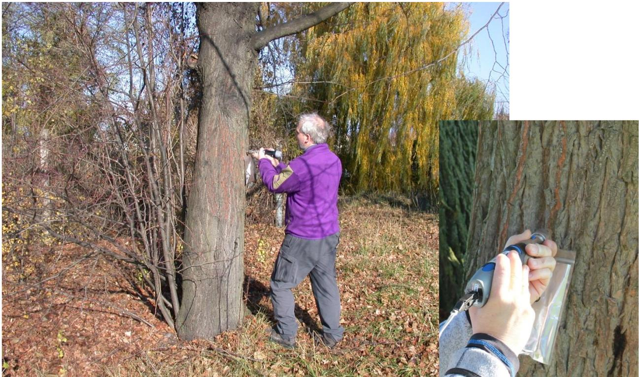
**Abb. 27: Standardisierte Entnahme der äußeren Rinde zum Luftgüte-Rindenmonitoring mit dem Rindenprobenehmer (Archivbild Hofmann)**
