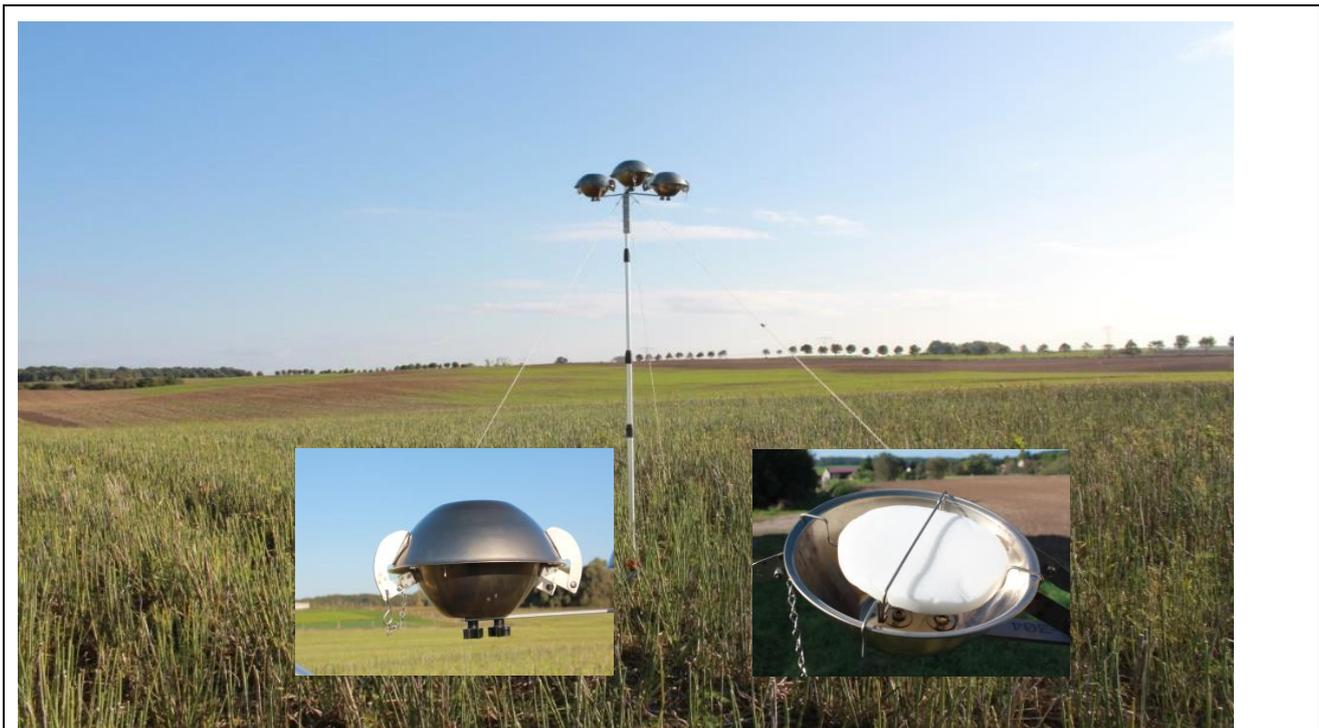
**Abb. 28: Technische Passivsammler PAS**
