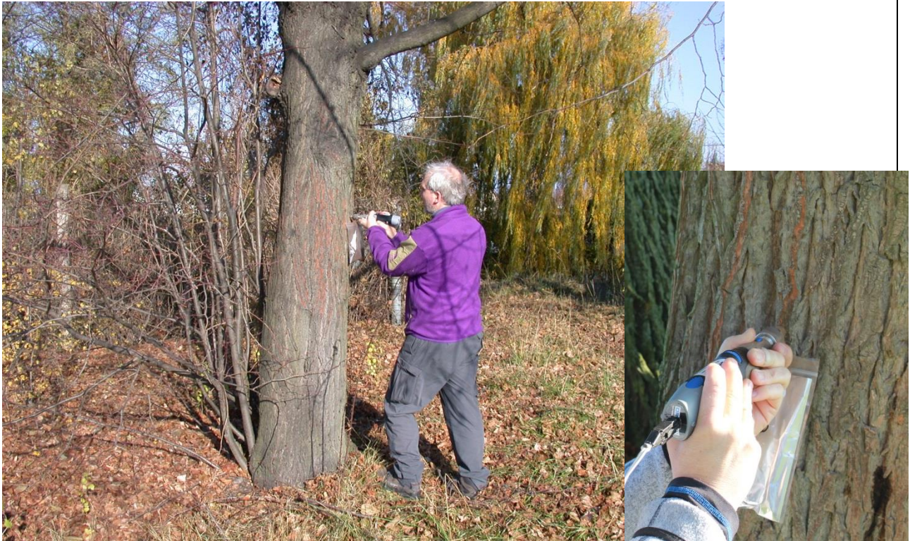
Abb. 1: Standardisierte Entnahme der äußeren Rinde zum Luftgüte-Rindenmonitoring mit dem Rindenprobenehmer (Archivbild Hofmann)
