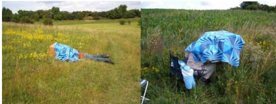
Abb. 19: Der Arbeitsplatz im Freiland mit dem Notebook muss zur besseren Erkennung des Bildschirminhaltes abgedunkelt werden. Am zweckmäßigsten erwies sich eine Arbeitsteilung: eine Person bedient das Mikroskop in der Vegetation, eine weitere das Analyseprogramm am Notebook.
